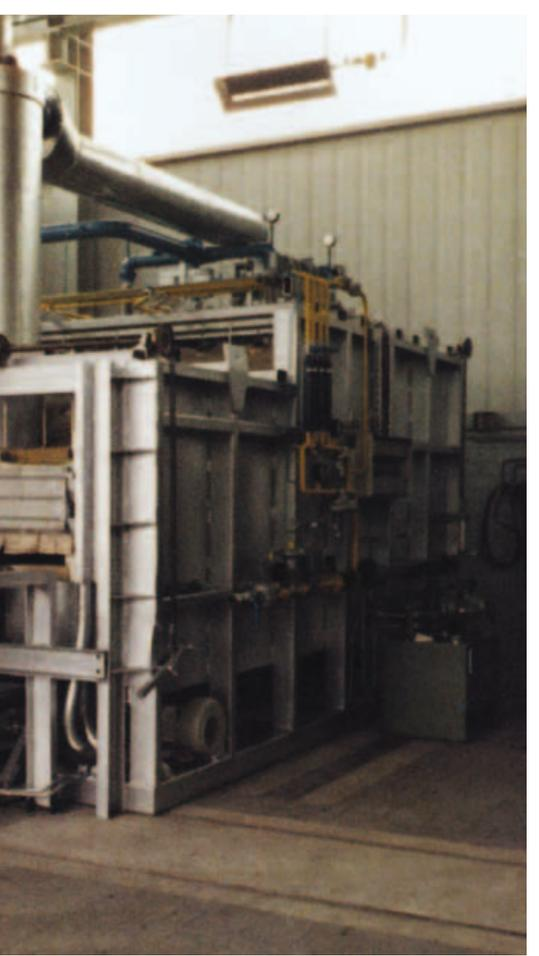
Der Haupteinsatzbereich für Hubbalkenöfen ist die Stahlindustrie. Hubbalkenöfen werden eingesetzt, um Knüppel und Blöcke in Normal- und Edelstahlqualitäten zu erwärmen und zur Weiterbearbeitung in Gesenken bzw. Schmiedeeinrichtungen vorzubereiten.
