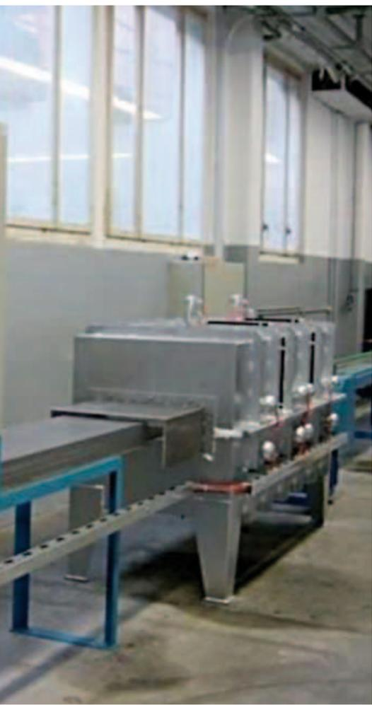
Das Glühgut (z.B. Rohrheizkörper) wird ohne Bänder, Ketten, Schlitten oder andere Transportvorrichtungen durch den Ofen gefördert. Die Rohrheizkörper werden durch einen Treibrollensatz, der sich vor dem Ofen befindet, durch den Ofen geschoben. Der Glüh- und Kühlkanal besteht aus einer Vielzahl von Röhren, deren Anzahl individuell gefertigt werden kann. Der Innendurchmesser der Glüh- und Kühlrohre ist so bemessen, dass nur jeweils ein Rohrheizkörper eingeschoben werden kann.
