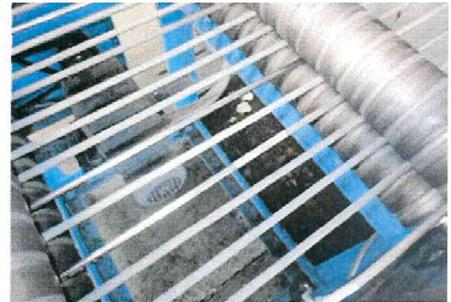
**Bild 8:** Treibrollen zur geraden Führung der Rohrheizkörper
