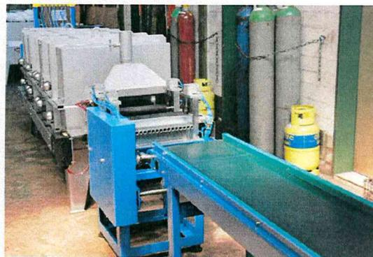
**Bild 4:** Glühofen nach FK-Verfahren
