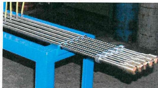
**Bild 5:** Gasdicht verschlossene Durchschubrohre
