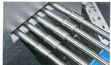
**Bild 11:** Verbindung Glüh-/Kühlrohre
