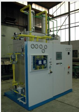
**Bild 4:** Endogas-Generator mit einer Nennleistung von 120 Nm<sup>3</sup>/h – Bauart Thermolen
